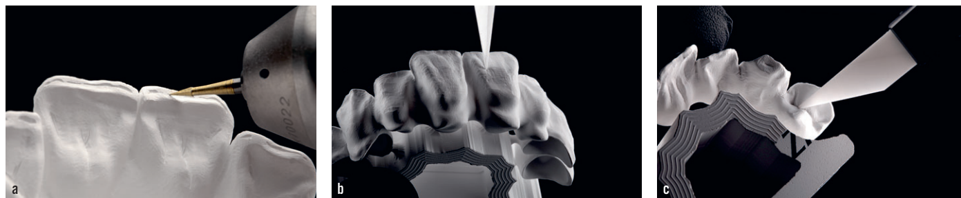
Fig. 12 a à c (a) Travail de morphologie sur une armature en zircone (avant le frittage) avec des outils rotatifs. (b et c) Technique de sculpture : réalisation d'une anatomie travaillée sur une armature en zircone (avant le frittage) avec un scalpel.
