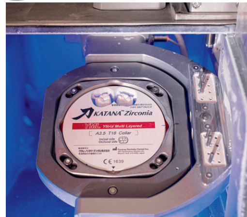
Fig. 10 La qualité du matériau influence la qualité de surface, la stabilité des bords, la précision d'adaptation et les exigences de traitement des restaurations fraisées.
